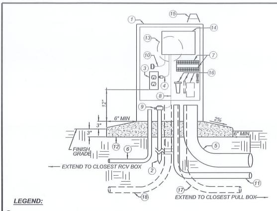
ELECTRICAL METER/IRRIGATION CONTROLLER ENCLOSURE W/ 110 VAC SERVICE PANEL-DOUBLE DOOR-STAINLESS STEEL (2) 5/8" x 8' COPPER-CLAD GROUNDING ROD (GROUND 110 & CONTROLLER)
